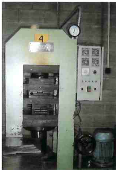
Figura 5 – Prensa aquecida para realizar a vulcanização.
