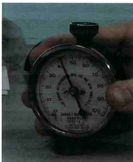
Figura 6 – Medição da dureza SHORE A da peça.
