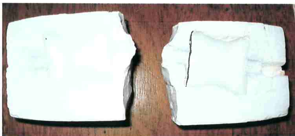
Figura 10 – Molde de gesso fabricado.
