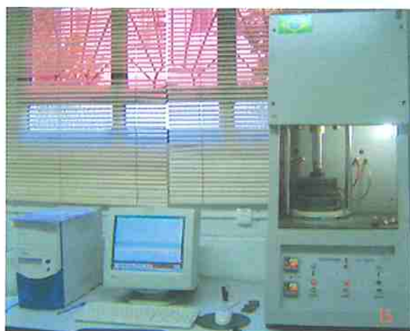
Figura 7 – Reômetro utilizado na análise reológica. Modelo TE100/03.
