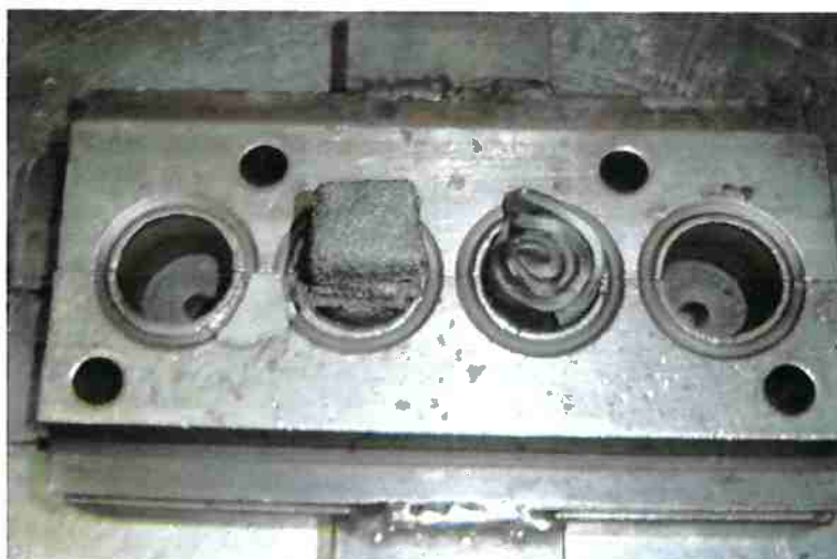
Figura 4 – Molde utilizado para fabricação do coxim.
